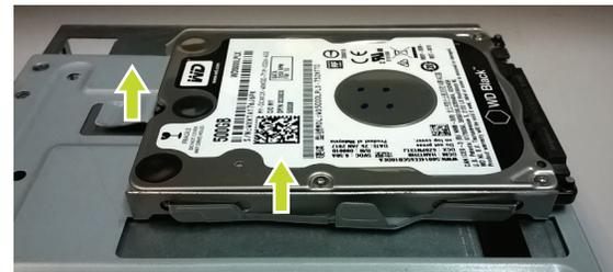
5. Para a troca do HDD, insira inclinando-o para encaixar nos pinos laterais e logo após pressione o outro lado para baixo e posicione as travas para o perfeito encaixe do HDD.
