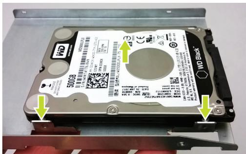
9. Após a troca do HDD insira novamente na baía e trave-o no gabinete, reconectando os cabos de alimentação e dados.
