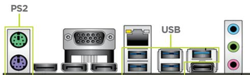
2. Conectar o cabo VGA, HDMI ou Display Port que acompanha o monitor na respectiva saída do microcomputador como indica a figura abaixo.
