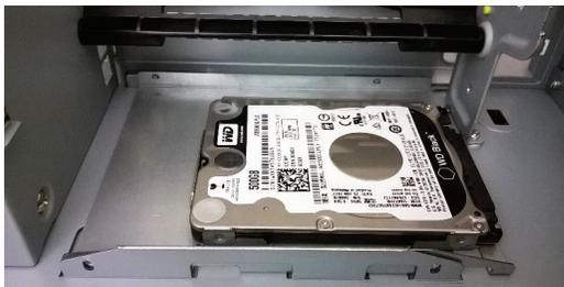
8. Para a remoção do HDD deve ser pressionado as duas travas laterais e puxar o HDD para cima, como mostra a figura abaixo.
