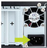
Observação: Verificar se a rede elétrica está de acordo com a faixa de operação da fonte. Verificar também se a tomada possui aterramento para uma boa proteção elétrica do equipamento.
