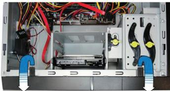
2. Desconecte os cabos conforme figura abaixo.
