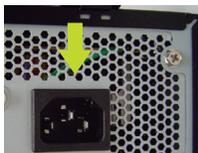
Observação: Verificar se a rede elétrica está de acordo com a faixa de operação da fonte. Verificar também se a tomada possui aterramento para uma boa proteção elétrica do equipamento.
