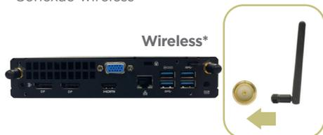
\*O módulo Wireless e o conector são opcionais. Antes da utilização das antenas, devem ser retirados os protetores dos conectores, localizados no painel traseiro do seu computador (conforme ilustração acima).
