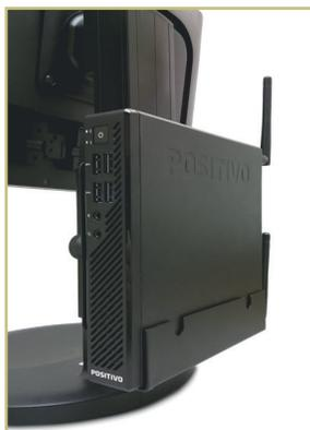
Posicionar a **peça frontal** conforme a ilustração acima, levá-la ao encontro da **peça traseira**, já instalada no pedestal do monitor. Atenção para que os furos de fixação dos parafusos das duas peças fiquem alinhados.
